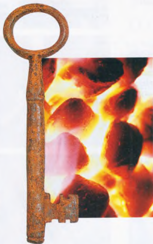
Figura 10. La oxidación del hierro es una reacción lenta que puede tomar meses en corroer el metal, mientras que la combustión del carbón es una reacción muy rápida que puede tomar pocos minutos.
