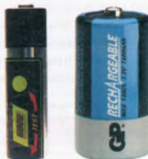
Figura 17. En las baterías, se transforma la energía química en energía eléctrica. La energía química proviene de reacciones de óxido-reducción, es decir, reacciones en las cuales los electrones pasan de un elemento a otro.
